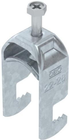
Bride de fixation avec pied F, plaque de pression en métal avec bords arrondis pour la protection des câbles. Pour montage vertical et horizontal d'un câble individuel sur des fers plats. Avec vis à 1 filet sur plaque de pression, tête de vis hexagonale universelle SW10, avec fente et empreinte cruciforme. Convient au montage en intérieur et en extérieur. L'utilisation d'une contre-plaque est recommandée.
