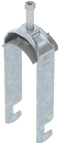
Bride de fixation avec pied F, plaque de pression en matière plastique en polypropylène. Pour montage vertical et horizontal de 2 câbles individuels sur des fers plats. Avec vis à 1 filet sur plaque de pression, tête de vis hexagonale universelle SW10, avec fente et empreinte cruciforme. Convient au montage en intérieur et en extérieur. Plusieurs câbles doivent être séparés par des plaques doubles. L'utilisation d'une contre-plaque est recommandée.
