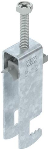
Bride de fixation avec pied F, plaque de pression en matière plastique en polypropylène. Pour montage vertical et horizontal de 3 câbles individuels sur des fers plats. Avec vis à 1 filet sur plaque de pression, tête de vis hexagonale universelle SW10, avec fente et empreinte cruciforme. Convient au montage en intérieur et en extérieur. Plusieurs câbles doivent être séparés par des plaques doubles. L'utilisation d'une contre-plaque est recommandée.
