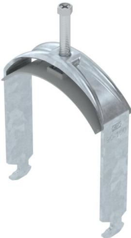
Bride de fixation avec pied H, plaque de pression en matière plastique en polypropylène. Pour montage vertical et horizontal d'1 câble individuel sur des rails profilés en C. Pour une ouverture de 16 – 17 mm. Avec vis à 1 filet sur plaque de pression, tête de vis hexagonale universelle SW10, avec fente et empreinte cruciforme. Convient au montage en intérieur et en extérieur. L'utilisation d'une contre-plaque est recommandée.
