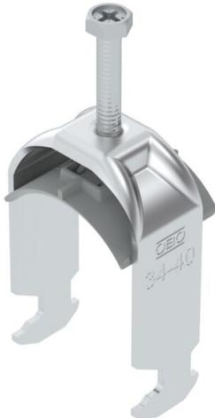
Bride de fixation avec pied H, plaque de pression en matière plastique en polypropylène. Pour montage vertical et horizontal d'1 câble individuel sur des rails profilés en C. Pour une ouverture de 16 – 17 mm. Avec vis à 1 filet sur plaque de pression, tête de vis hexagonale universelle SW10, avec fente et empreinte cruciforme. Convient au montage en intérieur et en extérieur. L'utilisation d'une contre-plaque est recommandée.
