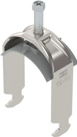
Bride de fixation avec pied H, plaque de pression en matière plastique en polypropylène. Pour montage vertical et horizontal d'1 câble individuel sur des rails profilés en C. Pour une ouverture de 16 – 17 mm. Avec vis à 1 filet sur plaque de pression, tête de vis hexagonale universelle SW10, avec fente et empreinte cruciforme. Convient au montage en intérieur et en extérieur. L'utilisation d'une contre-plaque est recommandée.
