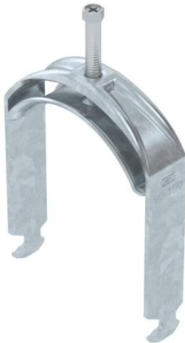
Bride de fixation avec pied H, plaque de pression en métal avec bords arrondis pour la protection des câbles. Pour montage vertical et horizontal d'1 câble individuel sur des rails profilés en C. Pour une ouverture de 16 – 17 mm. Avec vis à 1 filet sur plaque de pression, tête de vis hexagonale universelle SW10, avec fente et empreinte cruciforme. Convient au montage en intérieur et en extérieur. La contre-plaque doit être commandée séparément.
