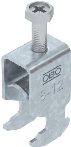
Bride de fixation avec pied H, plaque de pression en métal avec bords arrondis pour la protection des câbles. Pour montage vertical et horizontal d'1 câble individuel sur des rails profilés en C. Pour une ouverture de 16 – 17 mm. Avec vis à 1 filet sur plaque de pression, tête de vis hexagonale universelle SW10, avec fente et empreinte cruciforme. Convient au montage en intérieur et en extérieur. La contre-plaque doit être commandée séparément.
