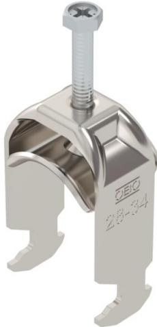
Bride de fixation avec pied H, plaque de pression en métal avec bords arrondis pour la protection des câbles. Pour montage vertical et horizontal d'1 câble individuel sur des rails profilés en C. Pour une ouverture de 16 – 17 mm. Avec vis à 1 filet sur plaque de pression, tête de vis hexagonale universelle SW10, avec fente et empreinte cruciforme. Convient au montage en intérieur et en extérieur. L'utilisation d'une contre-plaque est recommandée.
