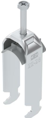
Bride de fixation avec pied H, plaque de pression en matière plastique en polypropylène. Pour montage vertical et horizontal de 2 câbles individuels sur des rails profilés en C. Pour une ouverture de 16 – 17 mm. Avec vis à 1 filet sur plaque de pression, tête de vis hexagonale universelle SW10, avec fente et empreinte cruciforme. Convient au montage en intérieur et en extérieur. Plusieurs câbles doivent être séparés par des plaques doubles. L'utilisation d'une contre-plaque est recommandée.
