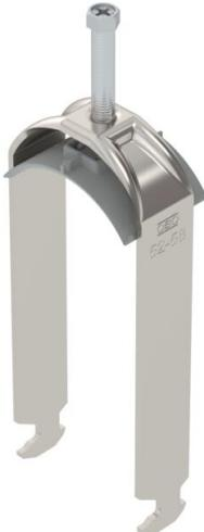
Bride de fixation avec pied H, plaque de pression en matière plastique en polypropylène. Pour montage vertical et horizontal de 2 câbles individuels sur des rails profilés en C. Pour une ouverture de 16 – 17 mm. Avec vis à 1 filet sur plaque de pression, tête de vis hexagonale universelle SW10, avec fente et empreinte cruciforme. Convient au montage en intérieur et en extérieur. Plusieurs câbles doivent être séparés par des plaques doubles. L'utilisation d'une contre-plaque est recommandée.
