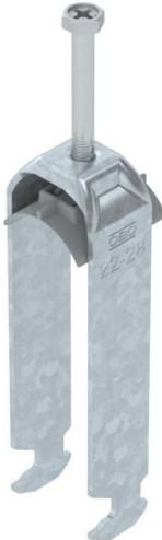
Bride de fixation avec pied H, plaque de pression en matière plastique en polypropylène. Pour montage vertical et horizontal de 3 câbles individuels sur des rails profilés en C. Pour une ouverture de 16 – 17 mm. Avec vis à 1 filet sur plaque de pression, tête de vis hexagonale universelle SW10, avec fente et empreinte cruciforme. Convient au montage en intérieur et en extérieur. Plusieurs câbles doivent être séparés par des plaques doubles. L'utilisation d'une contre-plaque est recommandée.
