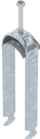
Bride de fixation avec pied H, plaque de pression en matière plastique en polypropylène. Pour montage vertical et horizontal de 3 câbles individuels sur des rails profilés en C. Pour une ouverture de 16 – 17 mm. Avec vis à 1 filet sur plaque de pression, tête de vis hexagonale universelle SW10, avec fente et empreinte cruciforme. Convient au montage en intérieur et en extérieur. Plusieurs câbles doivent être séparés par des plaques doubles. L'utilisation d'une contre-plaque est recommandée.
