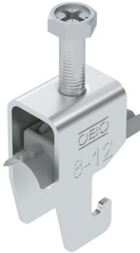
Bride de fixation avec pied U, plaque de pression en matière plastique en polypropylène. Pour montage vertical et horizontal d'1 câble individuel sur des rails profilés en C. Pour une ouverture de 18 – 22 mm. Avec vis à 1 filet sur plaque de pression, tête de vis hexagonale universelle SW10, avec fente et empreinte cruciforme. Convient au montage en intérieur et en extérieur. L'utilisation d'une contre-plaque est recommandée.
