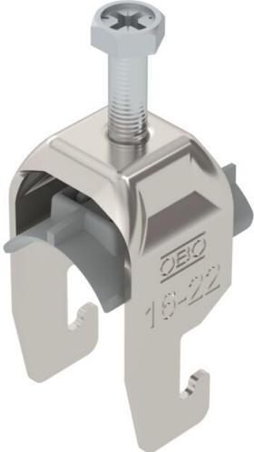
Bride de fixation avec pied U, plaque de pression en matière plastique en polypropylène. Pour montage vertical et horizontal d'1 câble individuel sur des rails profilés en C. Pour une ouverture de 18 – 22 mm. Avec vis à 1 filet sur plaque de pression, tête de vis hexagonale universelle SW10, avec fente et empreinte cruciforme. Convient au montage en intérieur et en extérieur. L'utilisation d'une contre-plaque est recommandée.
