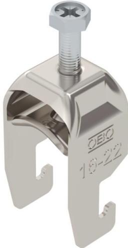
Bride de fixation avec pied U, plaque de pression en métal avec bords arrondis pour la protection des câbles. Pour montage vertical et horizontal d'1 câble individuel sur des rails profilés en C. Pour une ouverture de 18 – 22 mm. Avec vis à 1 filet sur plaque de pression, tête de vis hexagonale universelle SW10, avec fente et empreinte cruciforme. Convient au montage en intérieur et en extérieur. L'utilisation d'une contre-plaque est recommandée.
