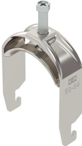
Bride de fixation avec pied U, plaque de pression métallique avec bords arrondis pour la protection des câbles. Pour montage vertical et horizontal d'1 câble individuel sur des rails profilés en C. Pour une ouverture de 18 – 22 mm. Avec vis à 1 filet sur plaque de pression, tête de vis hexagonale universelle SW10, avec fente et empreinte cruciforme. Convient au montage en intérieur et en extérieur. L'utilisation d'une contre-plaque est recommandée.
