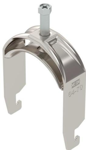
Bride de fixation avec pied U, plaque de pression métallique avec bords arrondis pour la protection des câbles. Pour montage vertical et horizontal d'1 câble individuel sur des rails profilés en C. Pour une ouverture de 18 – 22 mm. Avec vis à 1 filet sur plaque de pression, tête de vis hexagonale universelle SW10, avec fente et empreinte cruciforme. Convient au montage en intérieur et en extérieur. L'utilisation d'une contre-plaque est recommandée.
