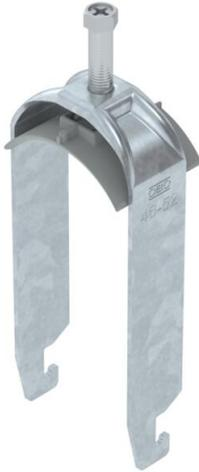
Bride de fixation avec pied U, plaque de pression en matière plastique en polypropylène. Pour montage vertical et horizontal de 2 câbles individuels sur des rails profilés en C. Pour une ouverture de 18 – 22 mm. Avec vis à 1 filet sur plaque de pression, tête de vis hexagonale universelle SW10, avec fente et empreinte cruciforme. Convient au montage en intérieur et en extérieur. Plusieurs câbles doivent être séparés par des plaques doubles. L'utilisation d'une contre-plaque est recommandée.
