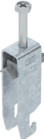
Bride de fixation avec pied U, plaque de pression en matière plastique en polypropylène. Pour montage vertical et horizontal de 3 câbles individuels sur des rails profilés en C. Pour une ouverture de 18 mm ou 22 mm. Avec vis à 1 filet sur plaque de pression, tête de vis hexagonale universelle SW10, avec fente et empreinte cruciforme. Convient au montage en intérieur et en extérieur. Plusieurs câbles doivent être séparés par des plaques doubles. L'utilisation d'une contre-plaque est recommandée.
