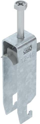
Bride de fixation avec pied U, plaque de pression en matière plastique en polypropylène. Pour montage vertical et horizontal de 3 câbles individuels sur des rails profilés en C. Pour une ouverture de 18 mm ou 22 mm. Avec vis à 1 filet sur plaque de pression, tête de vis hexagonale universelle SW10, avec fente et empreinte cruciforme. Convient au montage en intérieur et en extérieur. Plusieurs câbles doivent être séparés par des plaques doubles. L'utilisation d'une contre-plaque est recommandée.
