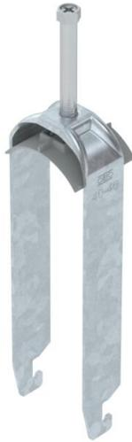
Bride de fixation avec pied U, plaque de pression en matière plastique en polypropylène. Pour montage vertical et horizontal de 3 câbles individuels sur des rails profilés en C. Pour une ouverture de 18 mm ou 22 mm. Avec vis à 1 filet sur plaque de pression, tête de vis hexagonale universelle SW10, avec fente et empreinte cruciforme. Convient au montage en intérieur et en extérieur. Plusieurs câbles doivent être séparés par des plaques doubles. L'utilisation d'une contre-plaque est recommandée.
