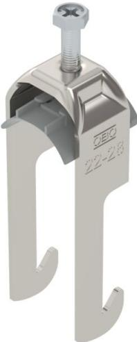
Bride de fixation avec pied W, plaque de pression en matière plastique en polypropylène. Pour montage vertical et horizontal d'1 câble individuel sur des cornières jusqu'à < 40 mm. Avec vis à 1 filet sur plaque de pression, tête de vis hexagonale universelle SW10, avec fente et empreinte cruciforme. Convient au montage en intérieur et en extérieur. L'utilisation d'une contre-plaque est recommandée.
