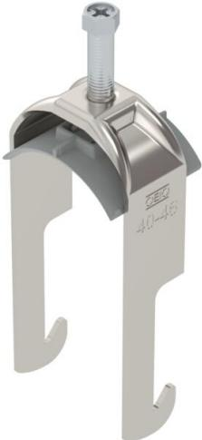
Bride de fixation avec pied W, plaque de pression en matière plastique en polypropylène. Pour montage vertical et horizontal d'1 câble individuel sur des cornières jusqu'à < 40 mm. Avec vis à 1 filet sur plaque de pression, tête de vis hexagonale universelle SW10, avec fente et empreinte cruciforme. Convient au montage en intérieur et en extérieur. L'utilisation d'une contre-plaque est recommandée.
