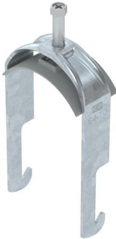
Bride de fixation avec pied W, plaque de pression en matière plastique en polypropylène. Pour montage vertical et horizontal d'1 câble individuel sur des cornières jusqu'à < 40 mm. Avec vis à 1 filet sur plaque de pression, tête de vis hexagonale universelle SW10, avec fente et empreinte cruciforme. Convient au montage en intérieur et en extérieur. L'utilisation d'une contre-plaque est recommandée.
