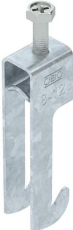
Bride de fixation avec pied W, plaque de pression métallique avec bords arrondis pour la protection des câbles. Pour montage vertical et horizontal d'1 câble individuel sur des cornières jusqu'à < 40 mm. Avec vis à 1 filet sur plaque de pression, tête de vis hexagonale universelle SW10, avec fente et empreinte cruciforme. Convient au montage en intérieur et en extérieur. L'utilisation d'une contre-plaque est recommandée.
