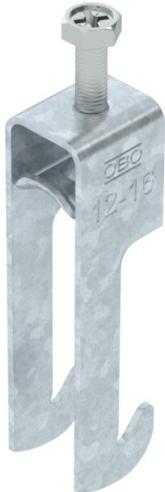
Bride de fixation avec pied W, plaque de pression métallique avec bords arrondis pour la protection des câbles. Pour montage vertical et horizontal d'1 câble individuel sur des cornières jusqu'à < 40 mm. Avec vis à 1 filet sur plaque de pression, tête de vis hexagonale universelle SW10, avec fente et empreinte cruciforme. Convient au montage en intérieur et en extérieur. L'utilisation d'une contre-plaque est recommandée.
