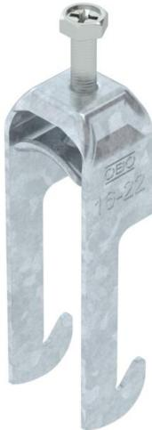
Bride de fixation avec pied W, plaque de pression métallique avec bords arrondis pour la protection des câbles. Pour montage vertical et horizontal d'1 câble individuel sur des cornières jusqu'à < 40 mm. Avec vis à 1 filet sur plaque de pression, tête de vis hexagonale universelle SW10, avec fente et empreinte cruciforme. Convient au montage en intérieur et en extérieur. L'utilisation d'une contre-plaque est recommandée.
