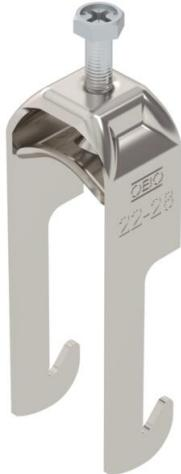
Bride de fixation avec pied W, plaque de pression en métal avec bords arrondis pour la protection des câbles. Pour montage vertical et horizontal d'1 câble individuel sur des cornières jusqu'à < 40 mm. Avec vis à 1 filet sur plaque de pression, tête de vis hexagonale universelle SW10, avec fente et empreinte cruciforme. Convient au montage en intérieur et en extérieur. L'utilisation d'une contre-plaque est recommandée.
