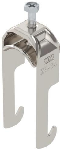
Bride de fixation avec pied W, plaque de pression en métal avec bords arrondis pour la protection des câbles. Pour montage vertical et horizontal d'1 câble individuel sur des cornières jusqu'à < 40 mm. Avec vis à 1 filet sur plaque de pression, tête de vis hexagonale universelle SW10, avec fente et empreinte cruciforme. Convient au montage en intérieur et en extérieur. L'utilisation d'une contre-plaque est recommandée.
