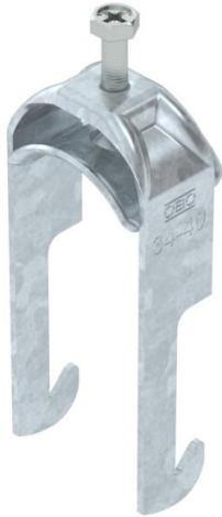
Bride de fixation avec pied W, plaque de pression métallique avec bords arrondis pour la protection des câbles. Pour montage vertical et horizontal d'1 câble individuel sur des cornières jusqu'à < 40 mm. Avec vis à 1 filet sur plaque de pression, tête de vis hexagonale universelle SW10, avec fente et empreinte cruciforme. Convient au montage en intérieur et en extérieur. L'utilisation d'une contre-plaque est recommandée.
