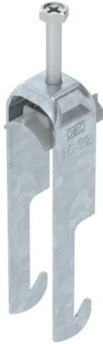
Bride de fixation avec pied W, plaque de pression en matière plastique en polypropylène. Pour montage vertical et horizontal de 2 câbles individuels sur des cornières jusqu'à < 40 mm. Avec vis à 1 filet sur plaque de pression, tête de vis hexagonale universelle SW10, avec fente et empreinte cruciforme. Convient au montage en intérieur et en extérieur. Plusieurs câbles doivent être séparés par des plaques doubles. L'utilisation d'une contre-plaque est recommandée.
