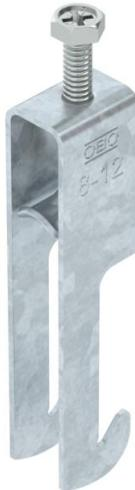
Bride de fixation avec pied W, plaque de pression métallique avec bords arrondis pour la protection des câbles. Pour montage vertical et horizontal de 2 câbles individuels sur des cornières jusqu'à < 40 mm. Avec vis à 1 filet sur plaque de pression, tête de vis hexagonale universelle SW10, avec fente et empreinte cruciforme. Convient au montage en intérieur et en extérieur. L'utilisation d'une contre-plaque est recommandée.
