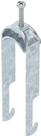
Bride de fixation avec pied W, plaque de pression métallique avec bords arrondis pour la protection des câbles. Pour montage vertical et horizontal de 2 câbles individuels sur des cornières jusqu'à < 40 mm. Avec vis à 1 filet sur plaque de pression, tête de vis hexagonale universelle SW10, avec fente et empreinte cruciforme. Convient au montage en intérieur et en extérieur. L'utilisation d'une contre-plaque est recommandée.
