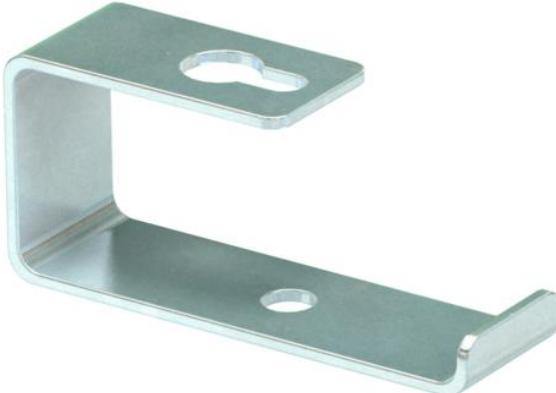
Étrier de déport pour faciliter le montage au plafond de la goulotte coupe-feu PY-ROLINE® Con D BSK, type BSK 090511 et type BSK 120511. Montage de l'étrier directement sur les chevilles de fixation de la goulotte coupe-feu.
