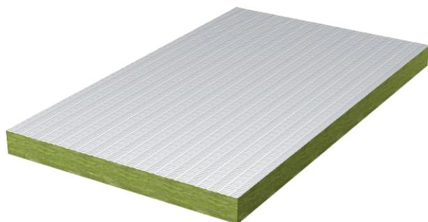
Panneau en fibres minérales, préenduit avec l'enduit ASX comme base pour la cloison douce. Plaque 50 mm pour calfeutrement selon homologation allemande, plaque 60 mm pour calfeutrement selon homologation européenne.
