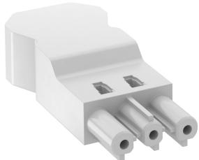
Fiche femelle à 3 pôles, type GST18i avec raccord à vis pour conduites 1,5 - 4,0 mm<sup>2</sup> pour une section de 10,5 à 14,5 mm (H05VV, NYM), non monté avec décharge de traction, possibilité de confection sur place, 250 V, 16 A.
