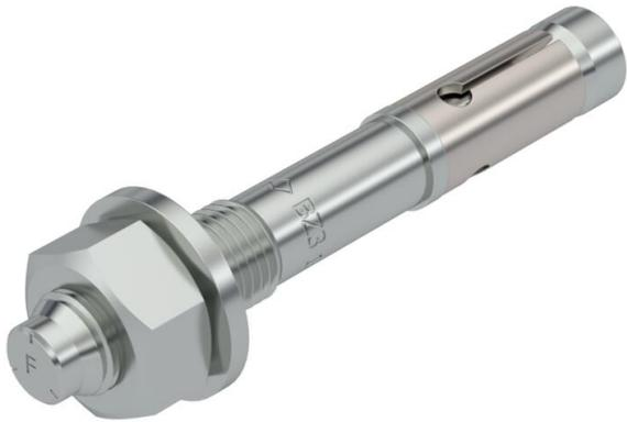
Boulon d'ancrage BZ3 pour ancrage de charges semi-lourdes et lourdes dans du béton fissuré ou non fissuré. Convient pour des charges admissibles élevées à de faibles entraxes et écartements entre les bords. À frapper.
