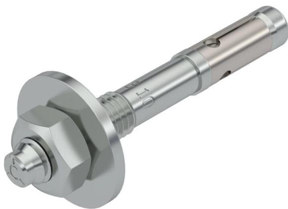
Boulon d'ancrage BZ3 pour ancrage de charges semi-lourdes et lourdes dans du béton fissuré ou non fissuré. Convient pour des charges admissibles élevées à de faibles entraxes et écartements entre les bords. À frapper.
