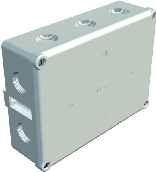
Indice de protection IP64, tension nominale 660 V, section nominale 16 mm<sup>2</sup>, 2 trous de fixation pour des vis jusqu'à 6 mm de Ø sur la face extérieure du boîtier. 4 vis de couvercle, 10 entrées défonçables avec filetage M25 x 1,5.
