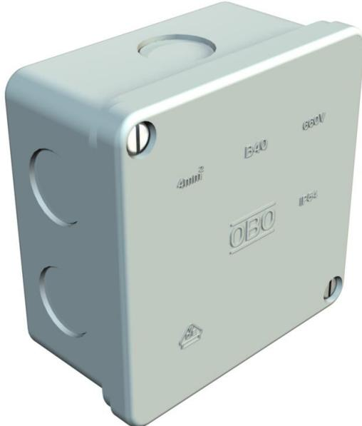
Indice de protection IP54, tension nominale 660 V, section nominale 4 - mm<sup>2</sup>, 2 trous de fixation pour vis jusqu'à 4,5 mm de Ø à l'intérieur du boîtier, mais en dehors de la zone de serrage. Filetage M 6 et surface de contact sur le fond du boîtier. 2 vis de couvercle,
