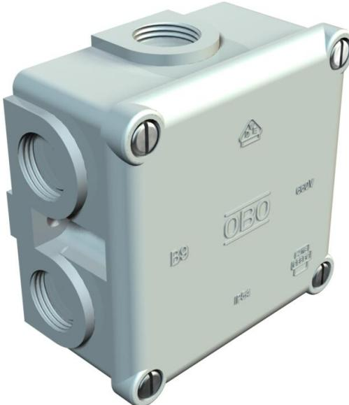
Classe de protection IP64, tension nominale 660 V, section nominale 2,5 mm<sup>2</sup>, 2 trous de fixation pour vis jusqu'à 5 mm Ø à l'extérieur du coffret, 4 vis de couvercle, 7 entrées défonçables avec filetage M20 x 1,5,, de préférence pour presse-étoupes à filetage court.
