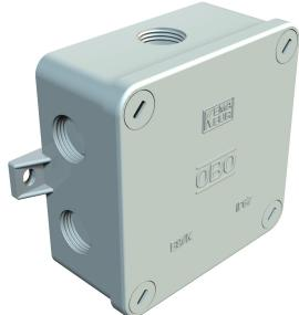
Indice de protection IP67, boîtier vide à utiliser avec des bornes individuelles, 4 vis pour couvercle en matière plastique (sécurité anti-corrosion), 2 pieds de fixation pour vis de 5 mm de Ø, 7 entrées défonçables avec filetage M20 x 1,5, 3 presse-étoupes en polyamide pour diamètres de câbles de 9 à 12 mm de type 106 M.
