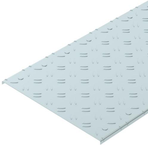
L'épaisseur de la couverture se compose d'une tôle d'acier galvanisée en bande de 2,0 mm et d'une hauteur d'ondulation de 1,3 mm.
