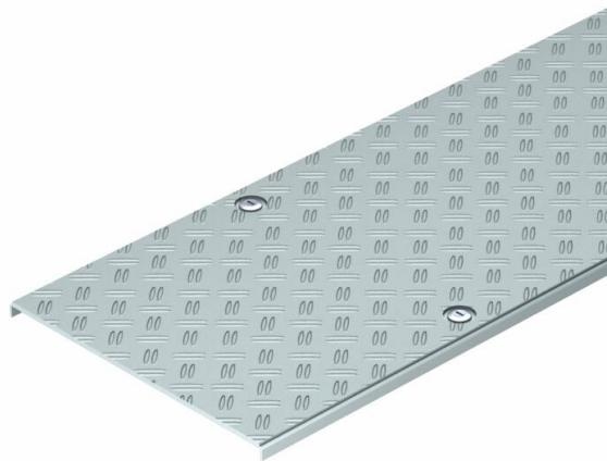
Couvercle de chemins de câbles pour système de chemins de câbles praticables BKRS. Revêtement de base en bande galvanisée avec une épaisseur de matériau de 2 mm avec une plaque à damier en aluminium rivetée supplémentaire en tant que motif duo avec une épaisseur de matériau de 4 mm, antidérapant et résistant au passage. Fixation par verrou tournant avec écart entre verrous tournants de 500 mm.
