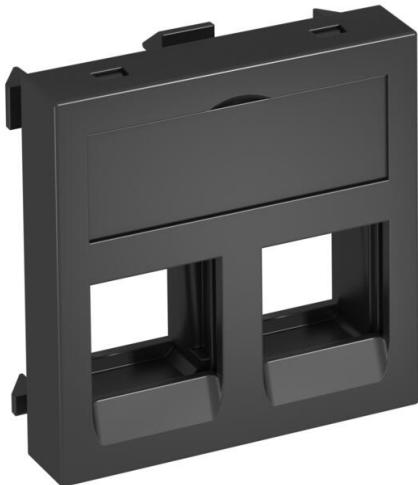
Support informatique avec sortie droite, sans pousoir d'obturation, pour le logement de deux noyaux informatiques avec prise RJ45 femelle. La fixation à encliquer convient pour le montage horizontal et vertical dans l'environnement du système. Le type C présente une ouverture de montage de 19,30 X 14,80 mm et est conçu pour la fixation directe des noyaux informatiques dans l'ouverture de montage.
