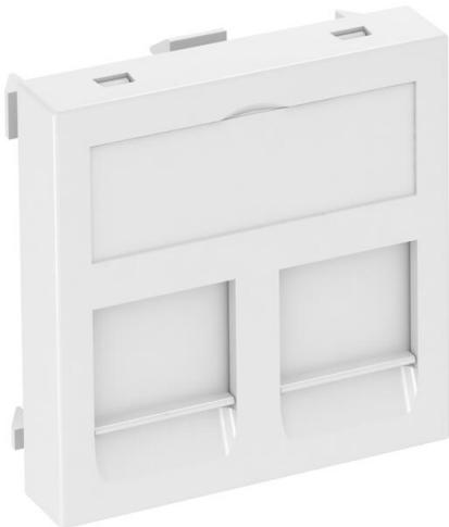
Support informatique avec sortie droite et poussoir d'obturation pour le logement de deux modules de raccordement informatiques avec prise RJ45 (femelle). La fixation à encliquer convient pour le montage horizontal et vertical dans l'environnement du système. Le type C présente une ouverture de montage de 19,30 X 14,80 mm et est conçu pour la fixation directe des noyaux informatiques dans l'ouverture de montage.
