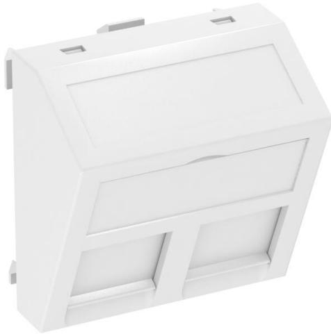
Support informatique avec sortie inclinée et poussoir d'obturation pour le logement de deux noyaux informatiques avec prise RJ45. La fixation à encliquer convient pour le montage horizontal et vertical dans l'environnement du système. Le type B présente une ouverture de montage de 19,35/21,55 X 14,85 mm et est conçu pour la fixation directe des noyaux informatiques dans l'ouverture de montage.
