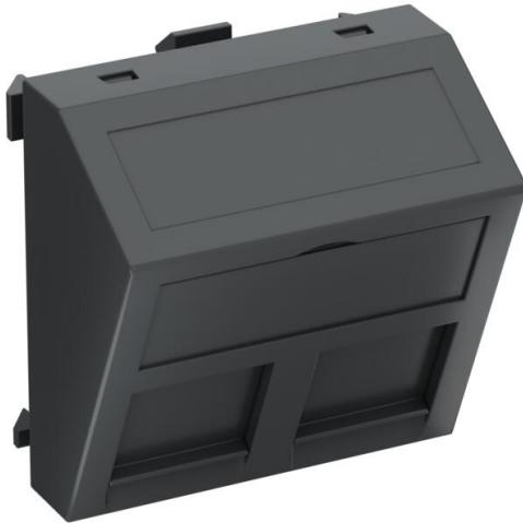
Support informatique avec sortie inclinée et poussoir d'obturation pour le logement de deux noyaux informatiques avec prise RJ45. La fixation à encliquer convient pour le montage horizontal et vertical dans l'environnement du système. Le type C présente une ouverture de montage de 19,30 X 14,80 mm et est conçu pour la fixation directe des noyaux informatiques dans l'ouverture de montage.
