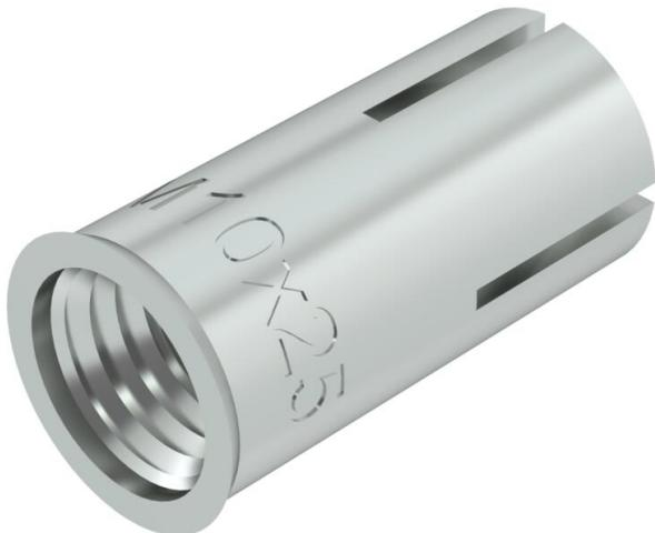
Cheville à frapper pour fixation unique de systèmes non porteurs dans du béton non fissuré et pour fixation multiple dans du béton fissuré et non fissuré
